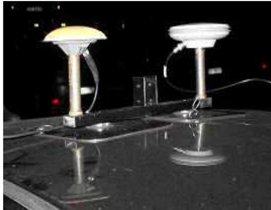
**Figura 3.** Le antenne rover utilizzate nel rilievo cinematico.
