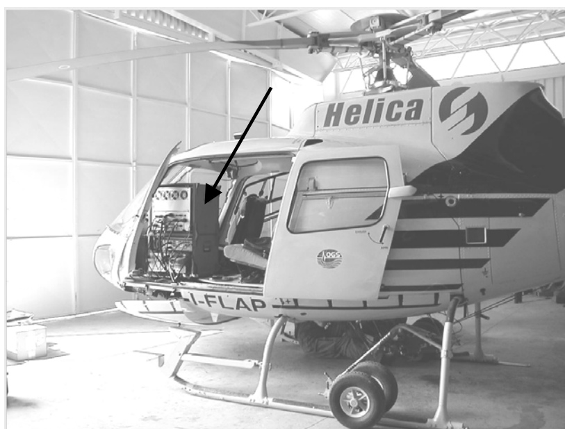
Figura 1. Sistema ALTM 3033 munito di sensore laser LIDAR
