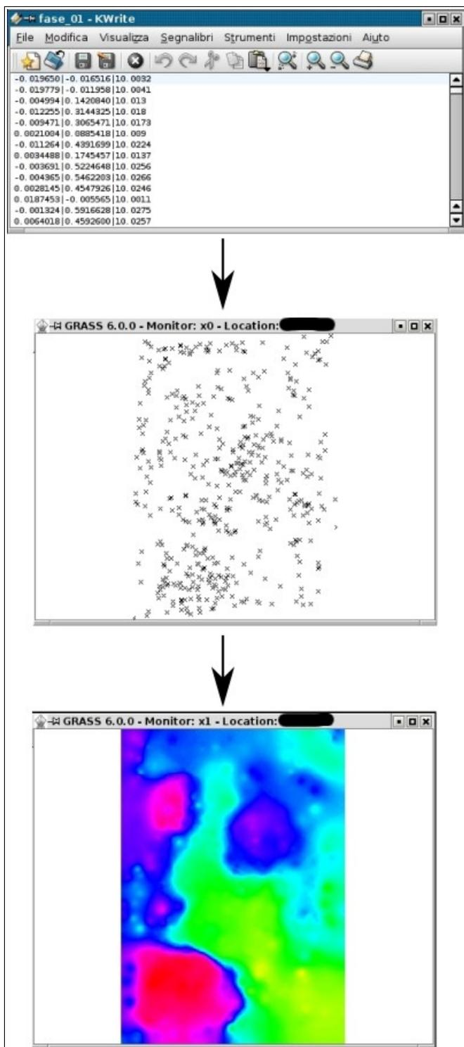
I dati utilizzati nel progetto erano essenzialmente di due tipi: per la ricostruzione dei volumi dei diversi strati archeologici sono state elaborate nuvole di punti realizzate attraverso la misura diretta delle diverse superfici (tramite stazione totale), integrata dalle informazioni raccolte attraverso l'utilizzo di software di stereorestituzione fotogrammetrica. Attraverso GRASS si è potuto trasformare i dati grezzi (punti) in modelli digitali delle superfici stesse (DEM).
